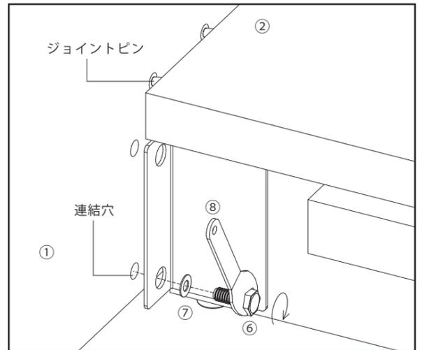
②サイドフレームと③センターフレームには両側面にジョイントピンが固定されています。ジョイントピンを対応する穴に差し込み、⑥ボルト、⑦ワッシャーを上図のような順番で連結穴に差し込んで⑧スパナで締めます。全ての連結穴をこの方法で締めていきます。
