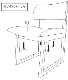
図例: Dining Side Chair プラスドライバーで上図のように ボルトを4本緩め、座を取り外します。
